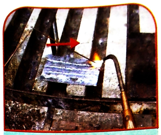
ภาพที่ 4.20 แสดงการเชื่อม Backhand และทิศทางการเชื่อม
